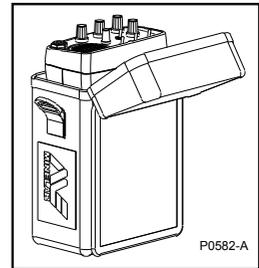
Figura 7 - Caja de control para la cintura
