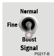
Este interruptor tiene tres niveles de respuesta: *Normal*, *Fine* y *Boost*. En posición *Normal*, la señal del objeto no sufre variación. Un cambio en la intensidad y volumen sirve para separar las señales del objeto de las del sonido de fondo.
