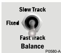
Este interruptor tiene tres posiciones *Automatic Fast Track* (Trazado automático rápido), *Automatic Slow Track* (Trazado automático lento), o *Fixed* (Fijo). En las dos posiciones automáticas, el Eureka Gold configura el balance de forma automática, para que el detector
